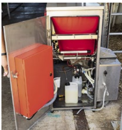
Die Technik reinigt die Milchleitungen bis zum Nuckel mit Chemie. Eine Heizung hält die Zirkulationsleitung im Winter auf Temperatur.
